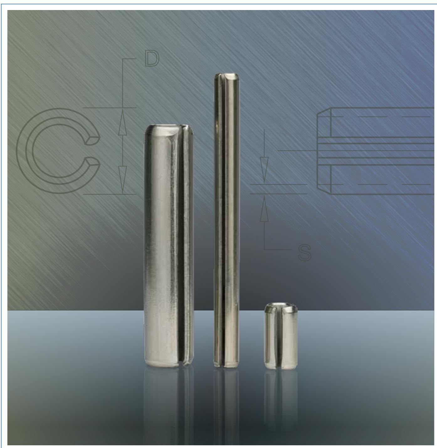
直槽弹性圆柱销是在许多紧固应用中使用的通用部件。在安装时受到压缩，该销向两侧孔壁施加持续的压力。因为在安装过程中销的两半会压缩，直槽销的主要弹性作用集中在与槽相对的区域。这种弹性使直槽弹性圆柱销比刚性实心销适用于更大的孔公差，从而降低了配合部件的制造成本。
