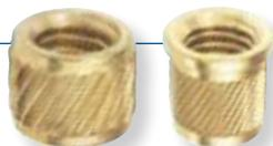
**压入型嵌件** 是使用较软塑料的最佳选择，提供了一个可重复使用的螺纹，可满足螺纹连接中较高的扭矩要求。螺旋滚花提供了中等的拉出力要求和较好的扭矩要求，同时也有利于良好的塑性流动。**50 系列**和**51系列**嵌件安装方便快捷。50系列嵌件为带有导入部分的对称设计。51系列为带头嵌件，同时也适用于大拉出阻力要求的穿透式应用。
