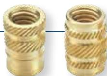
**19 和 29 系列** 是专为使用标准中心模销的直孔所设计的。相同的孔直径适用于这些系列的所有嵌件。导入部分以及锥形滚花和凹槽的设计有利于定位和安装。系列 29 为对称型，无需定向。
