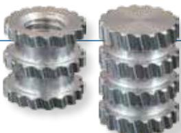
**模内嵌入型嵌件** 的设计是为了获得最大的拉出和扭矩性能，而且往往是填充剂含量较高的热固性塑料和工程塑料的嵌件选择。将螺纹直径公差控制到最小以确保在注塑过程中将嵌件精确定位和直立安装入中心销。**63 系列** 是无需定向的对称型，而 **65 系列** 则是同一主体类型的盲孔系列。这些嵌件是由重量轻，无铅级2024铝合金制成。
