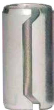
定位衬套用于配合螺栓固定部件，安装后螺栓会穿过衬套的内孔。不再需要为定位销准备单独的孔。硬化定位衬套也能吸收剪切载荷，将螺栓与这些力隔离开来。
