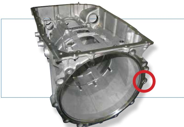
一个 OEM 使用一个 16 mm 外径的精密空心圆柱实心定位销将变速箱定位到发动机后部。这一特定的应用与大多数应用相比有更严格的要求，因为这两个需要对齐的组件的重量较大，且还要考虑连接方式。客户与 **SPIROL** 探讨降低成本的方法。
