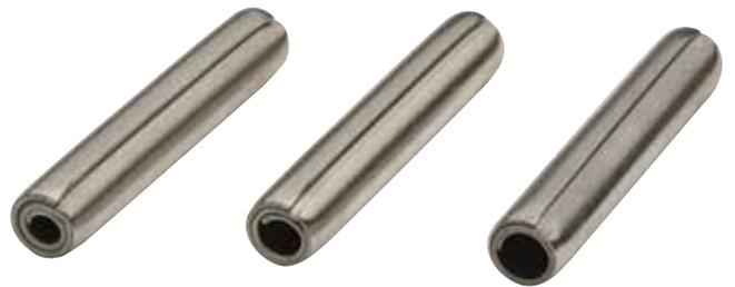
卷制弹性圆柱销的**载荷**（或材料）厚度可以改变，以提供强度和弹性的最优组合。较轻型载荷圆柱销需要的插入力较小，从而降低了自动化设备的成本，因为可以使用较小的气（油）缸和/或机器。在该销适合的应用中，易于自动装配的特点使其成为装配成本最低的紧固件。
