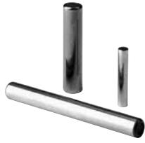
为了弥补实心定位圆柱销的一些不足，SPIROL 研制了**沟槽销**和**滚花销**。穿过沟槽和滚花的直径设计比孔要大。当硬化沟槽销用于获得强度时，主体材料会变形，但还没有达到圆柱实心销那样的程度。滚花销的设计旨在切入主体材料。但是，滚花销和沟槽销都不像圆柱实心销那样需要紧公差。无论如何，对于所有类型的实心销来说，插入力通常比较大，这会对自动化设备的成本产生巨大影响。此外，由于实心销需要主体材料产生塑性变形，以获得保持力，因此有可能在安装过程中造成部件破裂和/或损坏。
