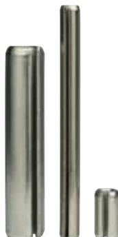
为了弥补实心圆柱销和直槽圆柱销的不足，SPIROL 研制了**卷制弹性圆柱销**。这些销采用条状材料制造，并被卷制成 1-1/2 或 2-1/4 圈的螺旋弹簧。该销的很多特点都有助于无故障自动装配。卷制弹性圆柱销不会套叠或互相嵌套，因为没有开口。除了销的固有弹性之外，整齐光洁的端面，再加上光滑、同轴度好的倒角和混合圆度，消除了任何可能割入孔壁的锐边和锐角，从而减小了插入力。倒角同轴度有助于与主体和配合孔对准。此外，该销也无需通过定向来获得强度。这些重要特性可以在生产过程期间极大地减少停机时间，降低设备成本，并实现无故障装配。
